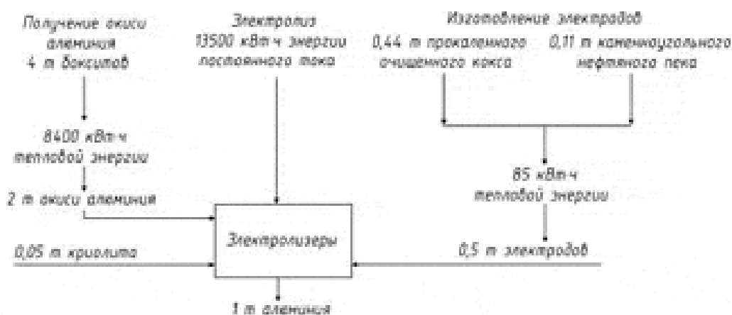
Рис. 3. Расход материалов и энергии на производство 1 т алюминия
